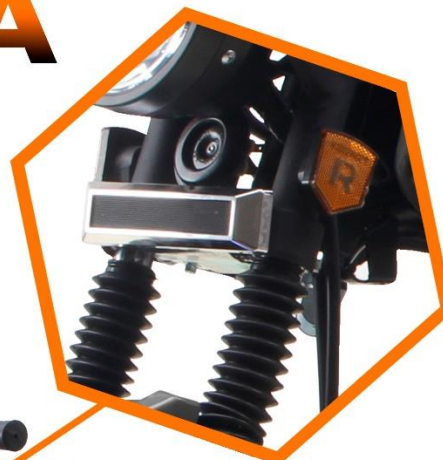
ТЕЛЕСКОПИЧЕСКАЯ ВИЛКА 650 мм
