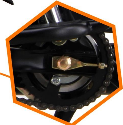
СТАЛЬНАЯ ВЕДОМАЯ ЗВЕЗДА 37 ЗУБЬЕВ
